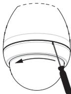
Figure 5.1: Rainure de déverrouillage de la sphère
