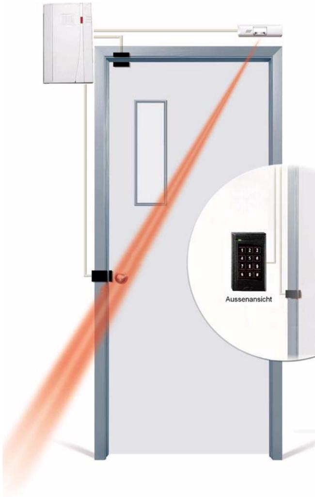
**Türgriff.** Die Außentürgriff (oder Drehknopf) sollte permanent verschlossen bleiben. Der Zugangskontroller sollte immer derjenige sein, der die Tür durch Entriegelung des elektrischen Schlosses öffnet. Der innere Türgriff sollte frei (unverschlossen) sein, um einen ungehinderten Ausgang in einer Notsituation zu erlauben. Um zu vermeiden, dass die Tür manuell offen steht, stellen Sie sicher, dass es keine Verriegelungs-/Entriegelungsknöpfe, am inneren Türkopf vorhanden sind.
