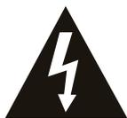
Le symbole représentant un éclair se terminant par une flèche dans un triangle équilatéral a pour objectif de signaler la présence d'une source de « tension dangereuse » non isolée dans le boîtier du produit et suffisamment puissante pour entraîner des risques de choc électrique.
