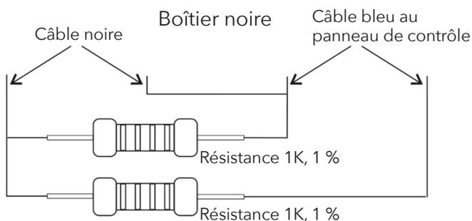
Résistance normale : 2K  $\Omega$  : Résistance alarme : 1K  $\Omega$
