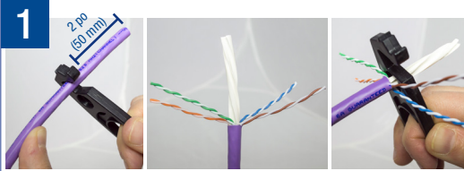
Séparateur cruciforme d'au plus 0,04 po (1 mm)
