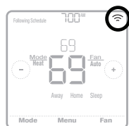
Exemple d'un thermostat inclus et connecté à un réseau Z-Wave. MFCR37009
