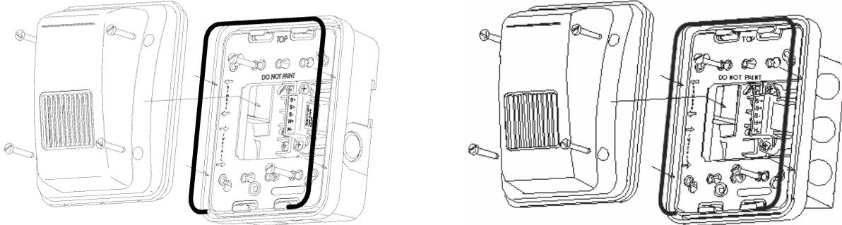
AVIS : L'OUVERTURE DU JOINT DOIT ÊTRE SITUÉE AU BAS DU BOÎTIER ARRIÈRE POUR PERMETTRE L'ÉVACUATION DE L'EAU.
