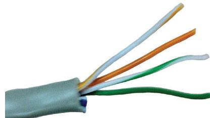
4. Die Kabel von links nach rechts fächerartig in der Reihenfolge anordnen, in der sie vercrimpt werden müssen. Die Konfiguration des Kabels kann der Tabelle 1 und Abbildung A entnommen werden.
