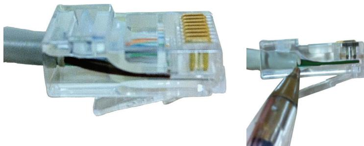
8. Olhar pelo lado do conector transparente e verificar se os fios chegaram até ao fundo. Posteriormente, introduzir o conector no alicate de crimpas e, apertando o alicate com as duas mãos, crimpar o conector de modo a cortar os fios. Não abrir o alicate até chegar ao fundo.
