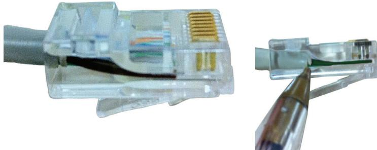
8. Guardando sul lato del connettore trasparente, verificate che i fili siano giunti sino in fondo. Quindi inserite il connettore nella pinza a crimpire e, stringendo la pinza con due mani, crimpate il connettore in modo da fermare i fili. La pinza non dovrebbe aprirsi se non si è giunti fino in fondo.
