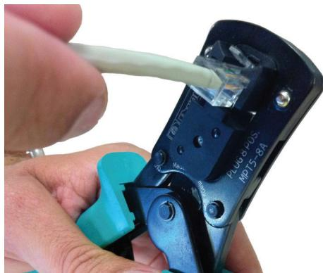
9. Anschließend die oben beschriebenen Vorgänge von Punkt 1 bis 8 wiederholen, um das Kabel am anderen Ende zu vercrimpen.
