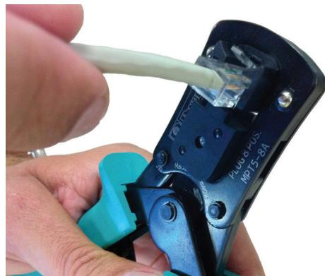
9. Ora ripetete esattamente i vari passaggi visti sopra nei punti da 1 a 8 per crimpate il cavo dall'altro lato.
