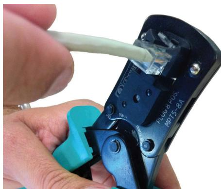
9. Répéter exactement les passages ci-dessus, du point 1 au point 8, pour sertir le câble de l'autre côté.
