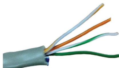
4. Dispor os cabos pela ordem em que deverão ser crimpados, da esquerda para a direita. Consultar a configuração do cabo na Tabela 1, Figura A.
