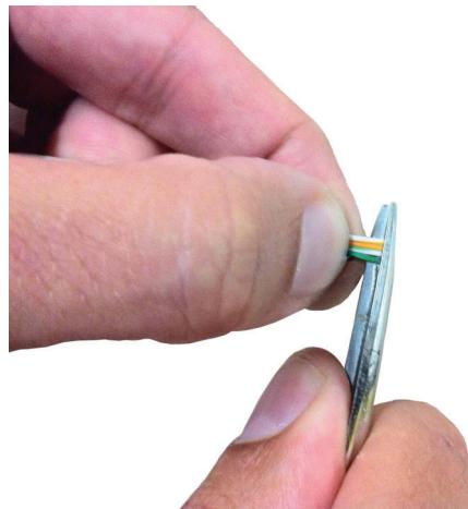
7. Włożyć przewody we wtyk RJ45, cały czas trzymając je palcami, aby były proste. Wypustka wtyku musi być u dołu, niewidoczna. Osłona izolacyjna musi sięgać dokładnie do krawędzi wtyku.
