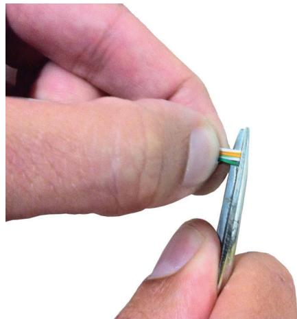
7. Telleri parmaklarınız arasında daima sıkıca dizilmiş şekilde tutarak RJ45 konnektörüne geçirin. Konnektörün dili aşağıda olmalı, görünmemelidir. Yalıtkan kılıf konnektör sınırının hemen yakınına ulaşmalıdır.
