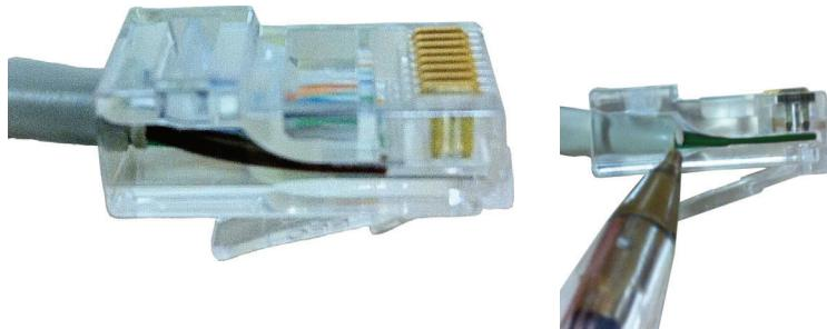
8. Bei Blick von der Seite auf den durchsichtigen Stecker müssen die Adern bis zum Ende im Stecker liegen. Dann den Stecker in die Crimpzange legen und mit beiden Händen den Stecker vercrimpen, um die Adern zu fixieren. Die Zange sollte sich nicht öffnen, wenn sie nicht bis zum Anschlag zugedrückt wurde.
