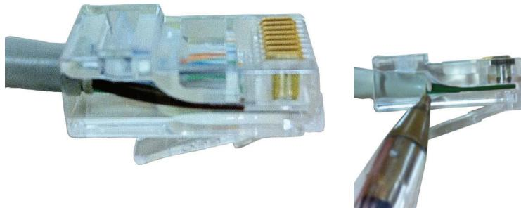
8. Mirando por el lado del conector transparente, controlar que los hilos hayan llegado hasta el fondo. Luego, introducir el conector en los alicates de engarzar y apretar los alicates con las dos manos para que los cables queden bien sujetos en el conector. No abrir los alicates hasta que no se haya llegado al tope.
