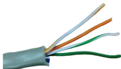
4. Disponete i cavi nell'ordine in cui dovete crimparli da sinistra a destra. La configurazione del cavo la potete vedere in Tabella 1 e Figura A.
