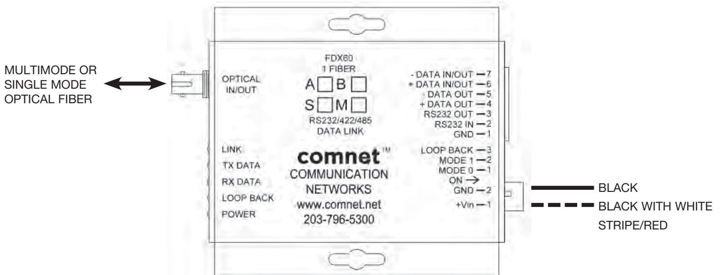
FIGURE 6 – FDX60-M 1 FIBER TRANSCEIVER
