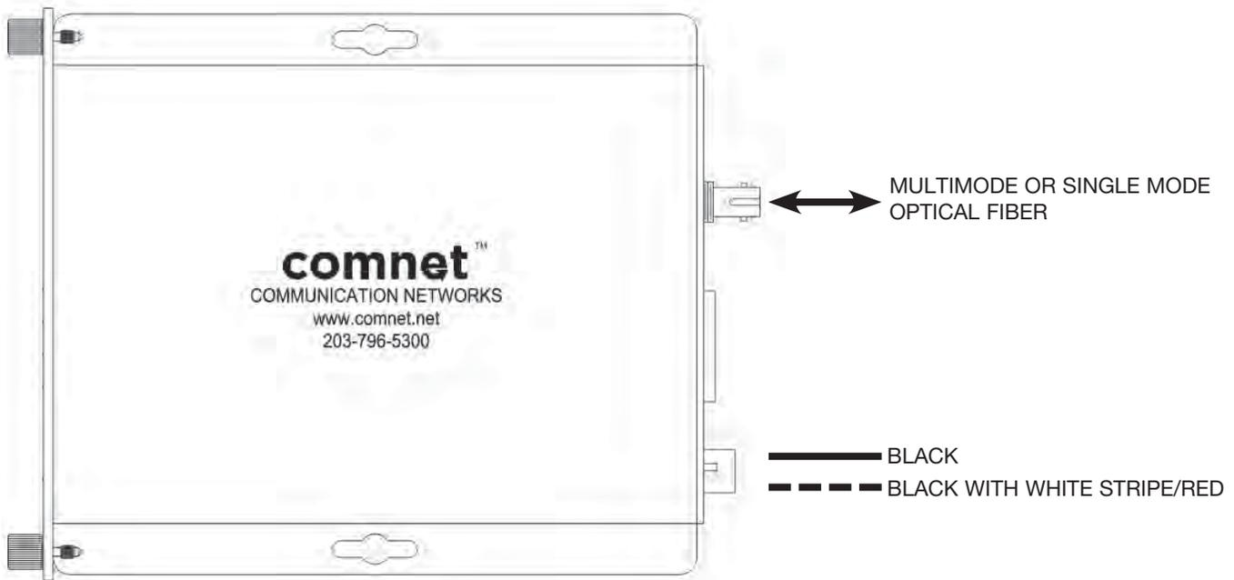
FIGURE 2 – FDX60 1 FIBER TRANSCEIVER
