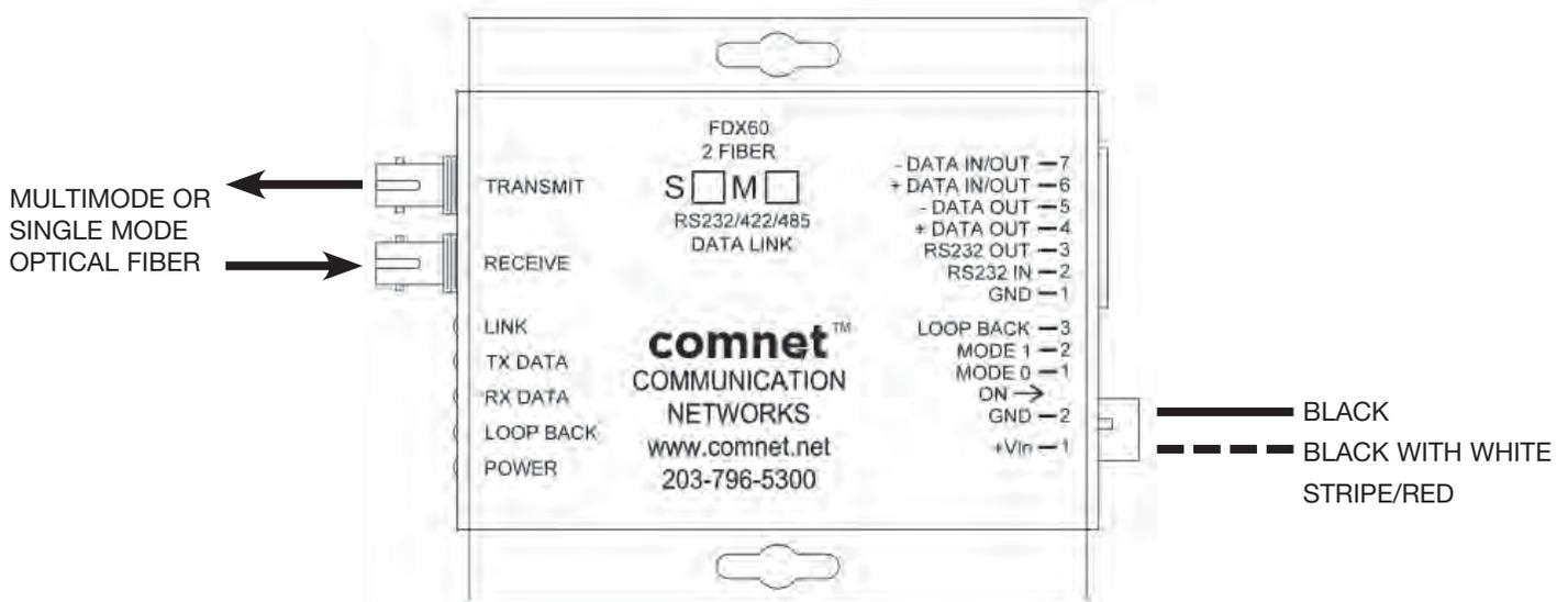
FIGURE 8 – FDX60-M 2 FIBER TRANSCEIVER
