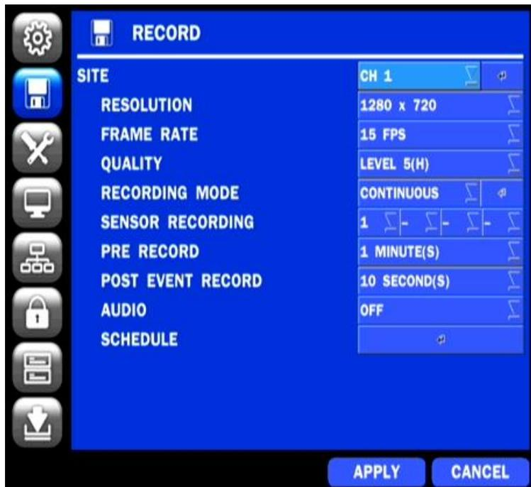
Figure 4.3.1. RECORD Setup Screen
